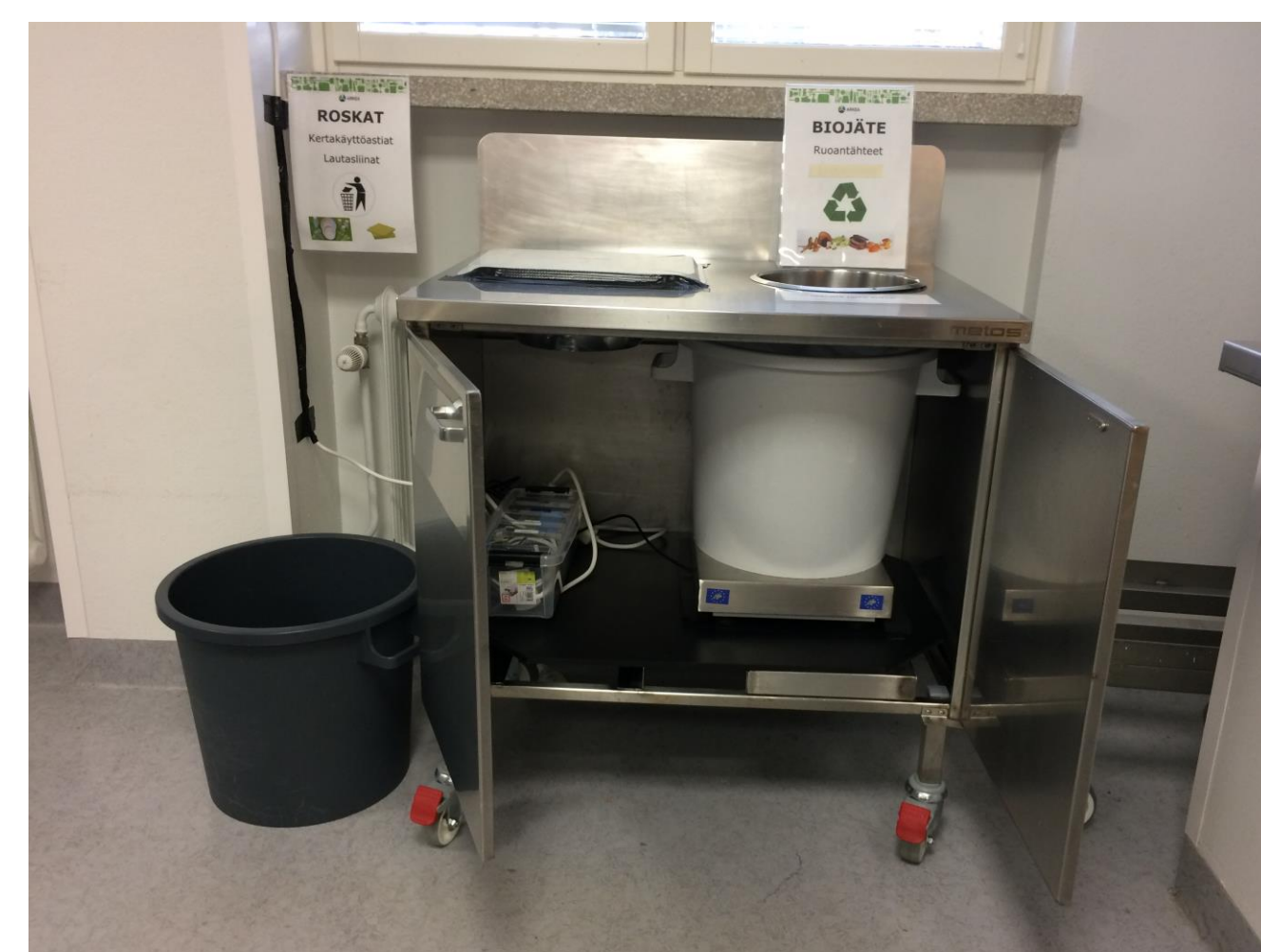
Astianpalautuksessa biojäteastian alle asennettu vaaka lähettää reaaliaikaista tietoa lautashävikin määrästä tutkimuskohteissa.
