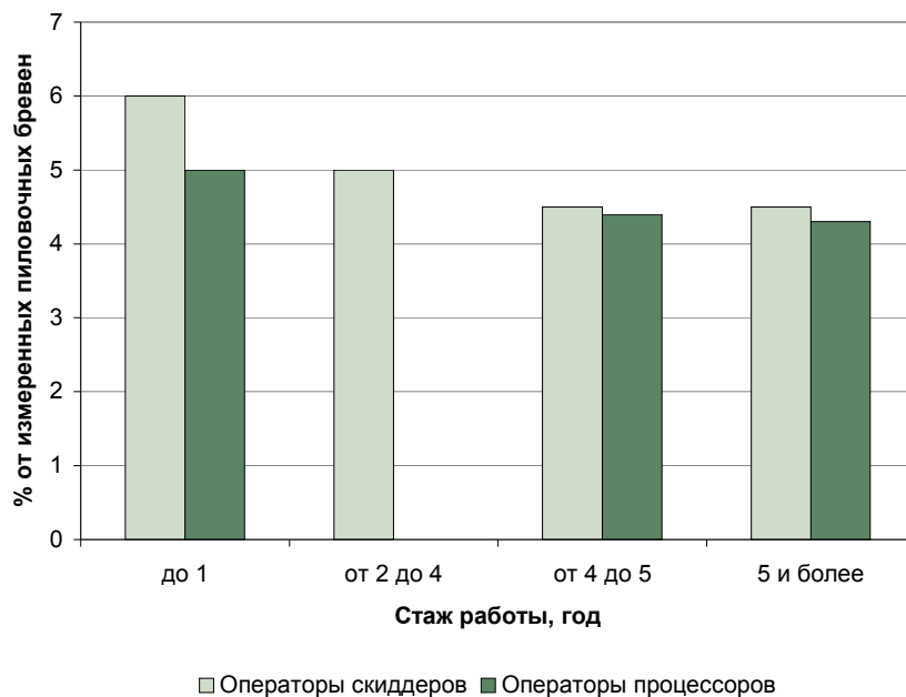
Рисунок 7. Изменение процента брака хвойных пиловочных бревен (летом) от стажа работы операторов скиддеров и процессоров.
