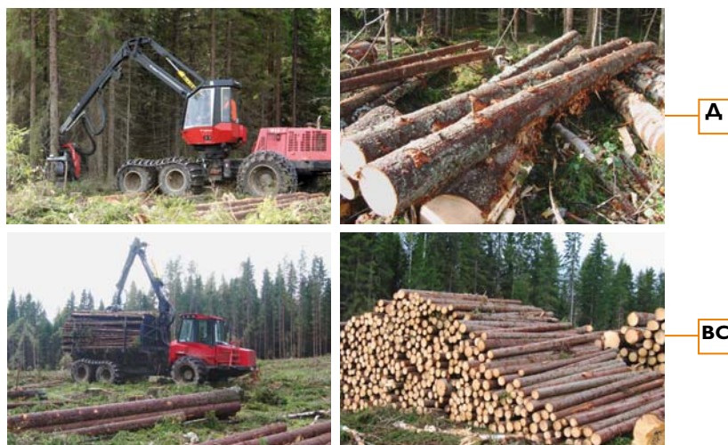
Рис. 5.2. Измерения сортиментов при заготовке машинизированным сортиментным методом (харвестер + форвардер): Д – на делянке, ВС – на верхнем складе (погрузочной площадке)
