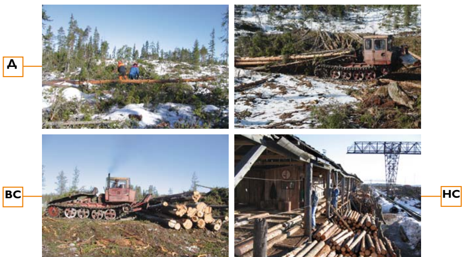
Рис. 5.3. Измерения при заготовке хлыстами (бензопила + трелевочный трактор): А – хлысты на делянке, ВС – хлысты на верхнем складе (погрузочной площадке), НС – сортименты на нижнем складе
