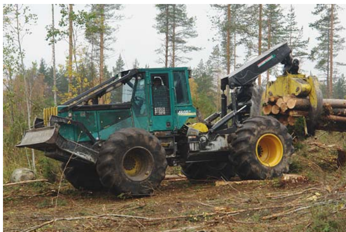
Рис. 4.31. Скиддер Timberjack 460D
