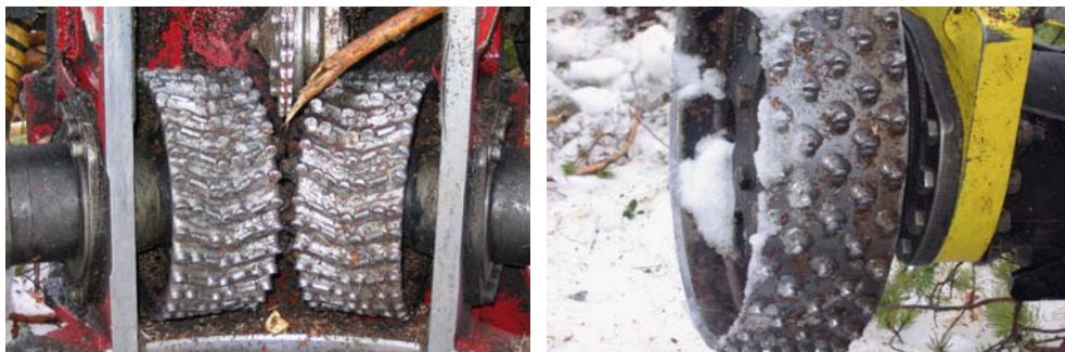
Рис. 5.22. Приводные стальные вальцы с изношенной ошиповкой
