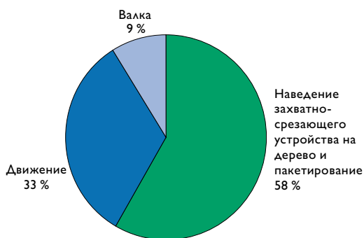
Рис. 4.13. Распределение времени внутри рабочего цикла валочнопакетирующей машины
