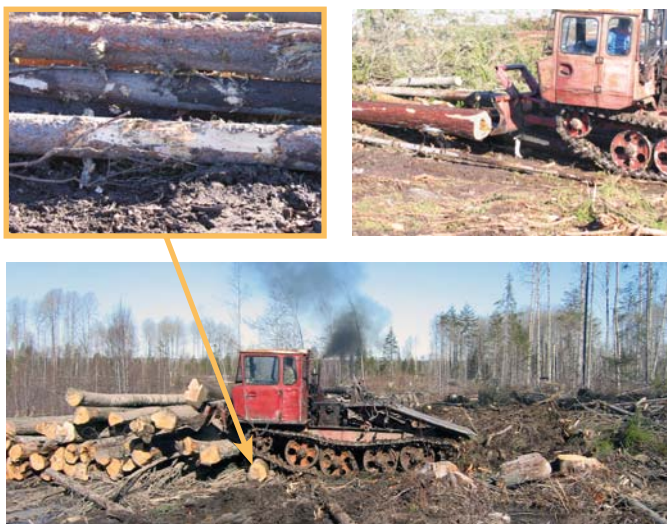
Рис. 5.19. Нарушение операции штабелевки хлыстов
