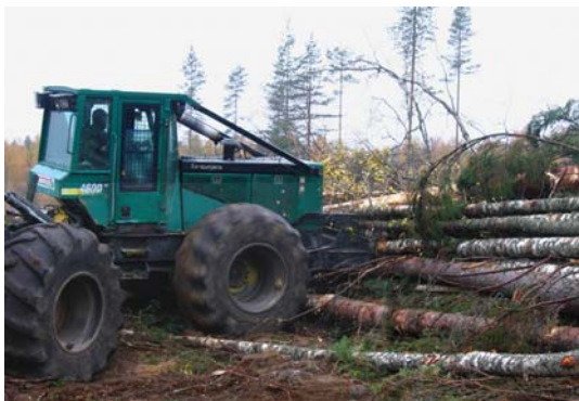
Рис. 5.25. Нарушение операции штабелевки деревьев
