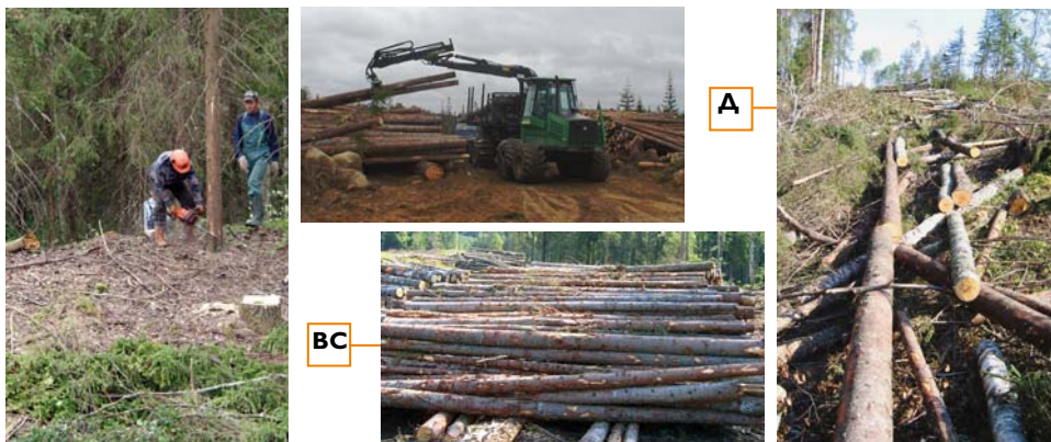
Рис. 5.1. Измерения сортиментов при заготовке механизированным сортиментным методом (бензопила + форвардер): Д – на делянке, ВС – на верхнем складе (погрузочной площадке)
