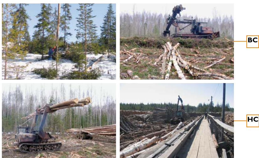
Рис. 5.4. Измерения при механизированной заготовке деревьями (бензопила + трелевочный трактор): ВС – хлысты на верхнем складе (погрузочной площадке), НС – сортименты на нижнем складе
