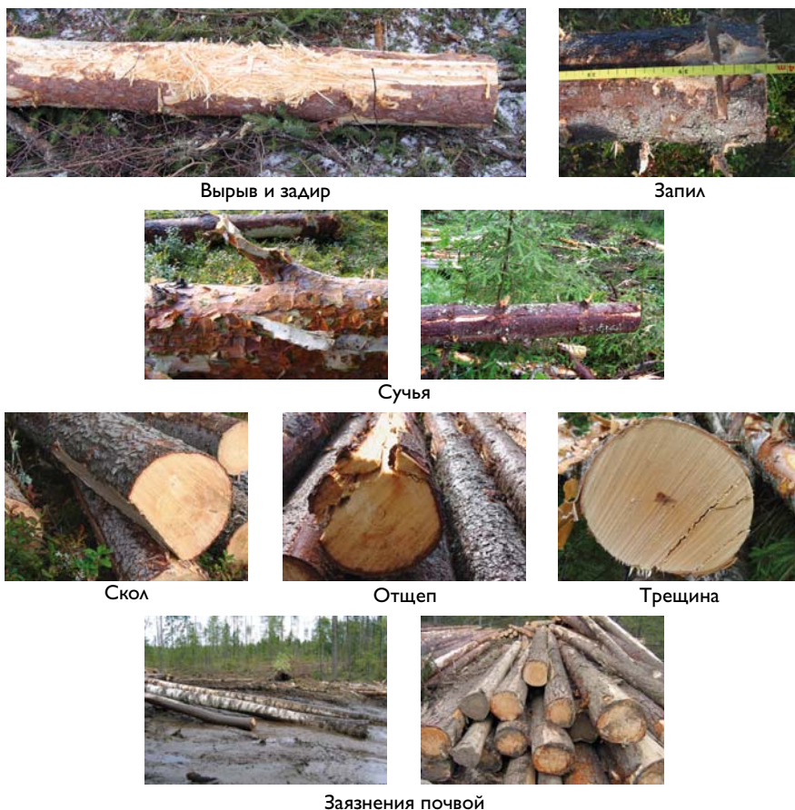
Рис. 5.6. Показатели, снижающие качество круглых лесоматериалов
