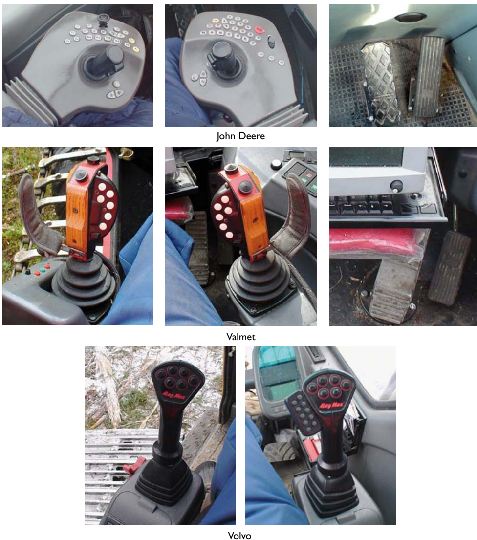
Рис. 4.7. Основные органы управления харвестеров
