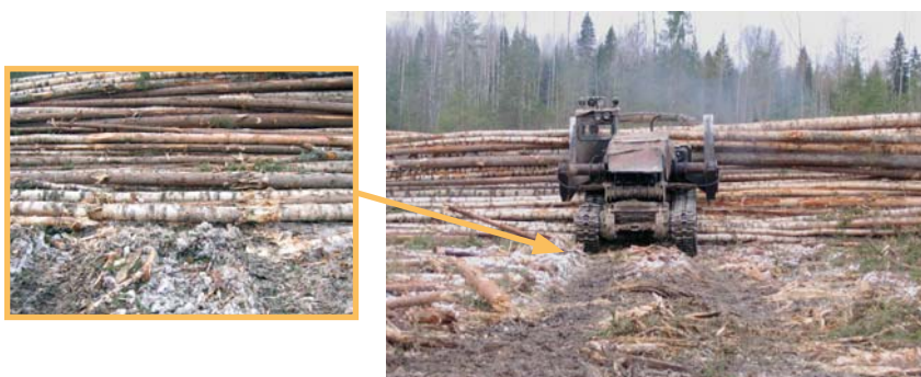
Рис. 5.21. Нарушение операции формирования пачки хлыстов
