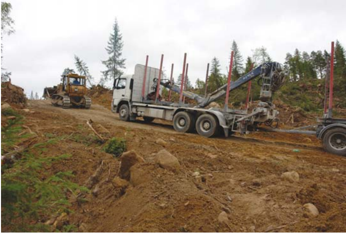
Рис. 1.5. Последствия неграмотного проектирования: лесовоз не может преодолеть подъем без помощи бульдозера, используемого в качестве тягача
