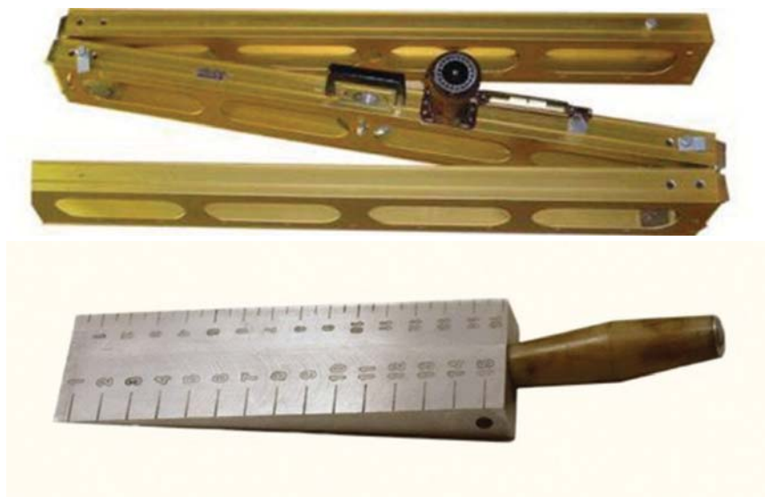
Рис. 3.17. Рейка РДУ «Кондор» и клиновой промерник
