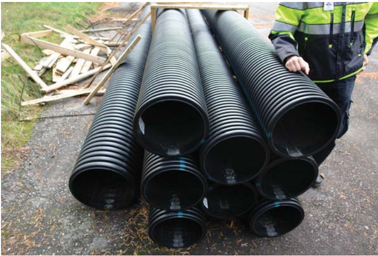
Рис. 1.8. Пластиковые гофрированные трубы диаметром 0,3 – 0,8 м повсеместно используются в Финляндии и все чаще находят применение на Северо-Западе РФ
