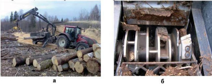
Рис. 1.24. Рубительные установки: а — рубительная машина Kesla, б — барабанный рабочий орган со съемными ножами
