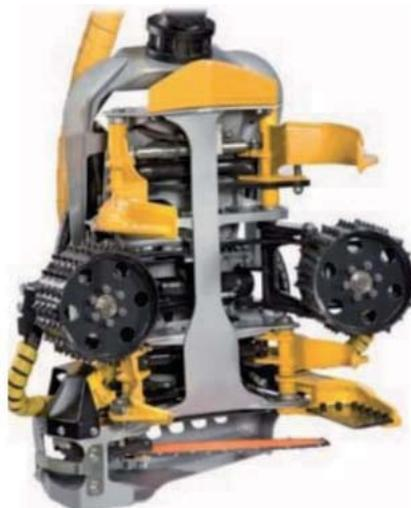
*Рис. 1.16.* Харвестерная головка Kesla 16RH с дополнительным ножевым срезающим устройством (компания «Kesla» [85])
