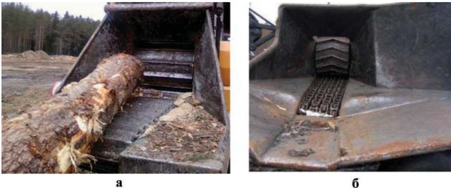
Рис. 1.25. Устройство для подачи сырья к рабочему органу: а — гусеничное, б — цепное
