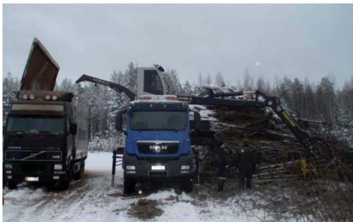
*Рис. 1.26.* Выработка щепы с одновременной загрузкой автомобиля-щеповоза
