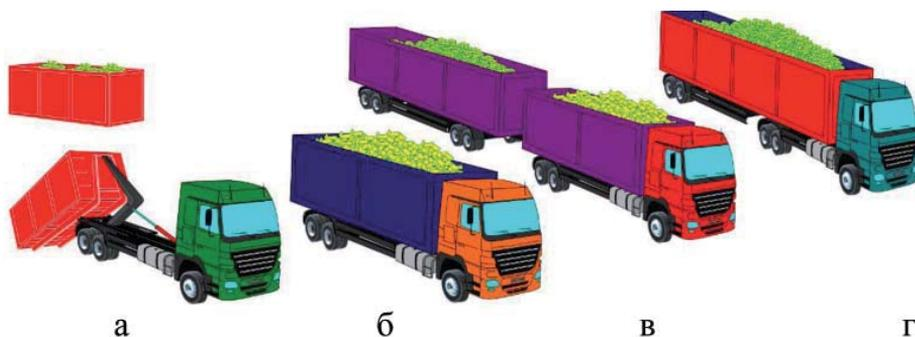
*Рис. 1.8.* Автотранспорт для транспортировки щепы: а — автомобиль-контейнеровоз со сменными контейнерами, б — автомобиль-щеповоз, в, г — автопоезда-щеповозы с прицепом и полуприцепом
