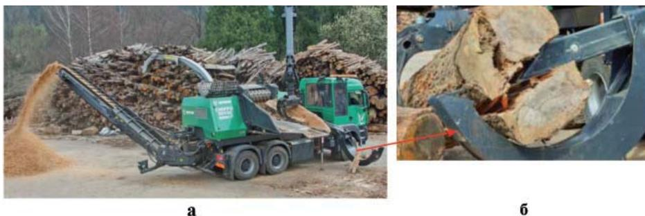
**Рис. 1.31.** Рубительная машина Komptech Chippo 5010C с автономным силовым приводным двигателем, гидроманипулятором и гидравлическими клещами (компания «Komptech» [91])
