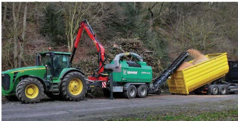
**Рис. 1.27.** Рубительная машина Komptech Chippo 510C на прицепной тележке, оснащенная щепопроводом и транспортером для выброса щепы (компания «Komptech» [88])
