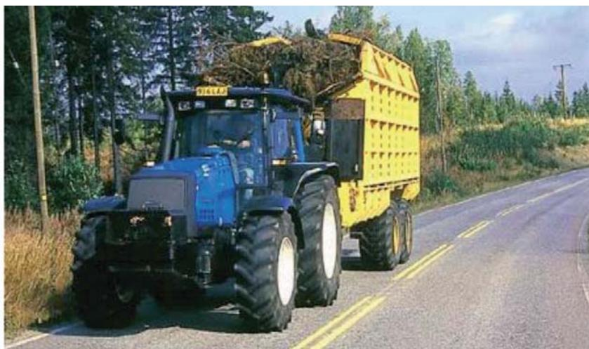
**Рис. 1.40.** Машина для сбора и транспортировки отходов на базе трактора марки Navo Hukka (компания «Varo Oy» [102])
