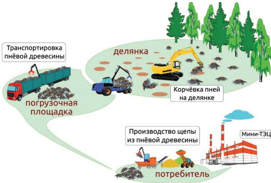
Рис. 1.10. Технология заготовки экскаватором и измельчения пнево-корневой древесины у потребителя
