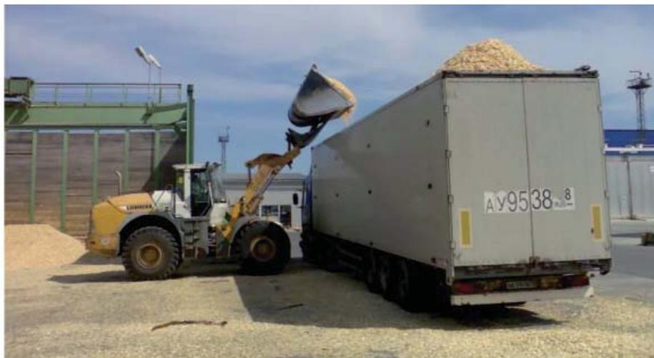
Рис. 1.42. Погрузка автопоезда-щеповоза лесопогрузчиком
