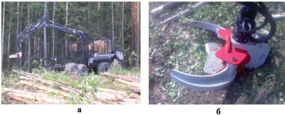
**Рис. 1.21.** Валочное устройство (ЗСУ) гильотинного типа, установленное на форвардер LOGSET 8F
