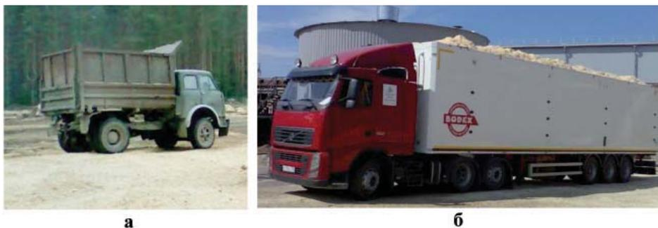
**Рис. 1.43.** Автопоезда-щеповозы: а — щеповоз на базе автомобиля МАЗ-509, б — автопоезд-щеповоз с полуприцепом на базе автомобиля Volvo
