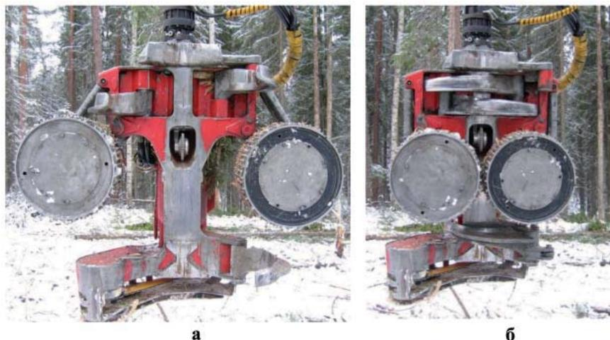
*Рис. 1.18.* Харвестерная головка Log Max 7000 с захватными рычагами, захватывающими дерево в плоскости оси дерева: а — захватные рычаги раскрыты, б — захватные рычаги в закрытом положении
