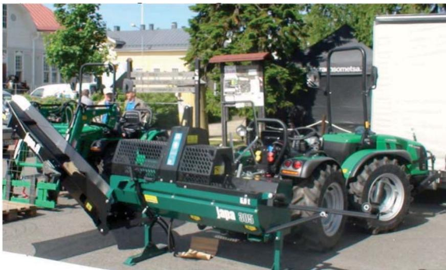
*Рис. 2.3.* Установка для производства дров Яра 305 с приводом от трактора
