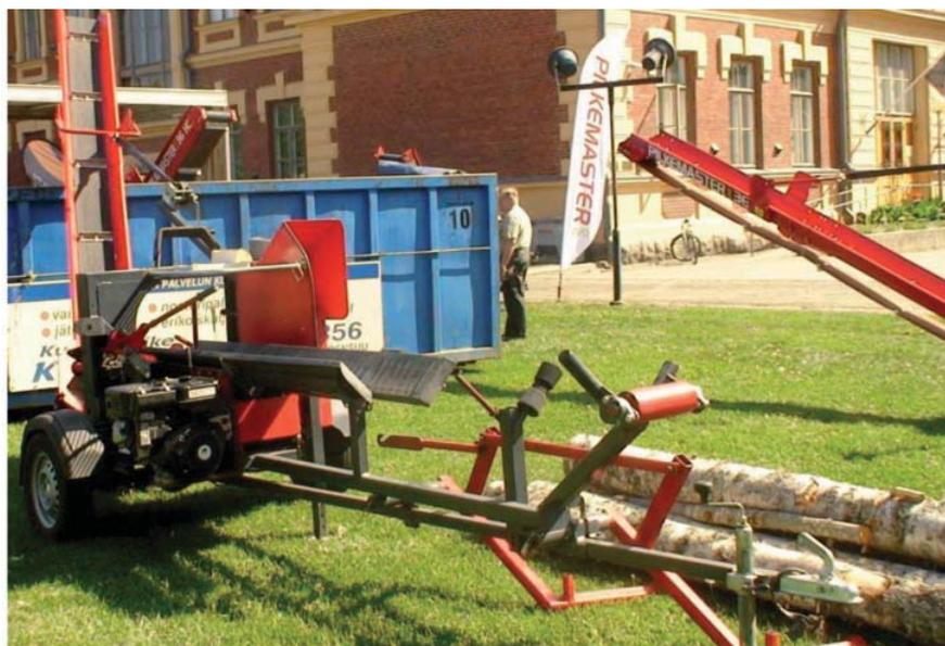
*Рис. 2.4.* Установка для производства дров Pilkemaster EVO на прицепной тележке с приводом от автономного двигателя
