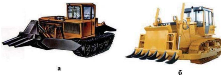
**Рис. 1.36.** Корчеватели: а — корчевальная машина КМ-1 [26], б — трактор Б10М с корчевателем (ООО «Челябинский тракторный завод — УРАЛТРАК» [99])
