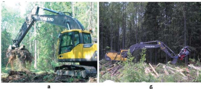
**Рис. 1.34.** Машины, способные производить корчевку пней: а — экскаватор Volvo EC210B, б — экскаватор-харвестер Volvo EC210BF со стрелой-ковшом
