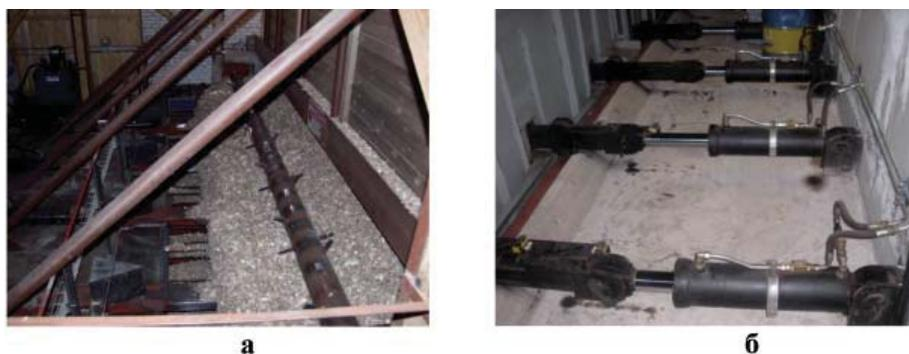
**Рис. 3.5.** Оборудование топливного склада: а — скребковый транспортер и вал-разрыхлитель, б — гидроцилиндры привода скребков
