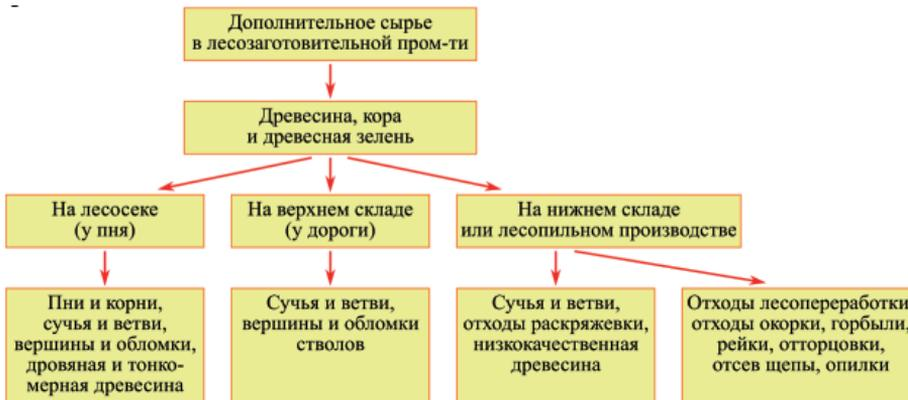
Рис. 1.2. Структура распределения дополнительного сырья в зависимости от технологии лесозаготовок
