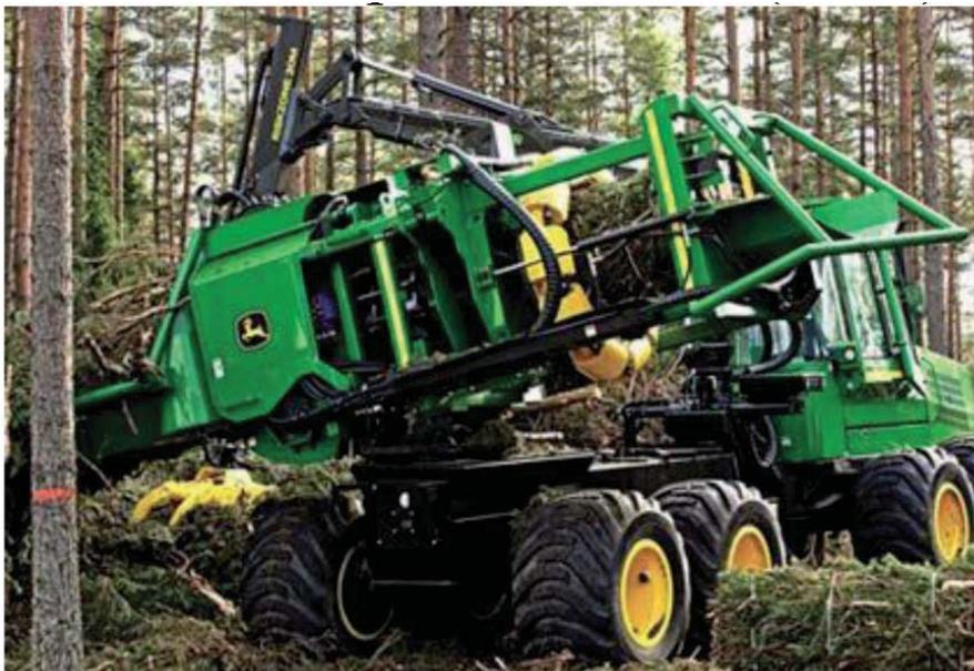
*Рис. 1.41.* Пакетирующий модуль Fiberpac на базе John Deere 1490D
