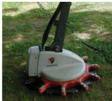
*Рис. 1.14.* Кусторез с дисковой пилой для агрегирования на манипуляторе лесосечной машины Usewood Pro
