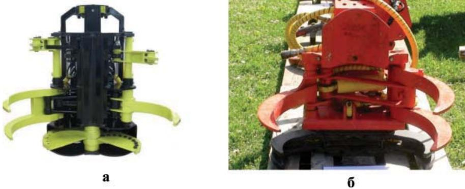
**Рис. 1.20.** Валочные головки: а — AFM 220 (компания «AFM Forest» [86]), б — Naarva-Koura 1000-23
