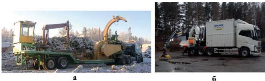
**Рис. 1.30.** Установка рубительной машины: а — Heinola на полуприцепе с автономным силовым приводным двигателем, гидроманипулятором и дополнительными устройствами, б — на шасси автощеповоза Volvo в агрегате с гидроманипулятором (компания «Bruks» [90])
