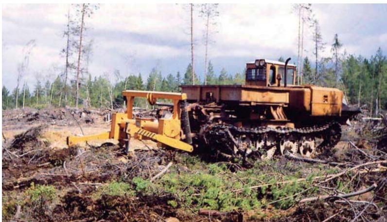
Рис. 1.17 Лункообразователь Л-2У в агрегате с трактором ЛХТ-55 (фото А. И. Соколова)
