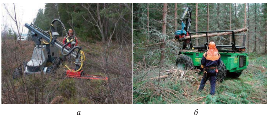
Рис. 2.31 Машины для рубок ухода с дистанционным управлением: а — Ebeaver [63]; б — харвардер RCM Harveri [64]
