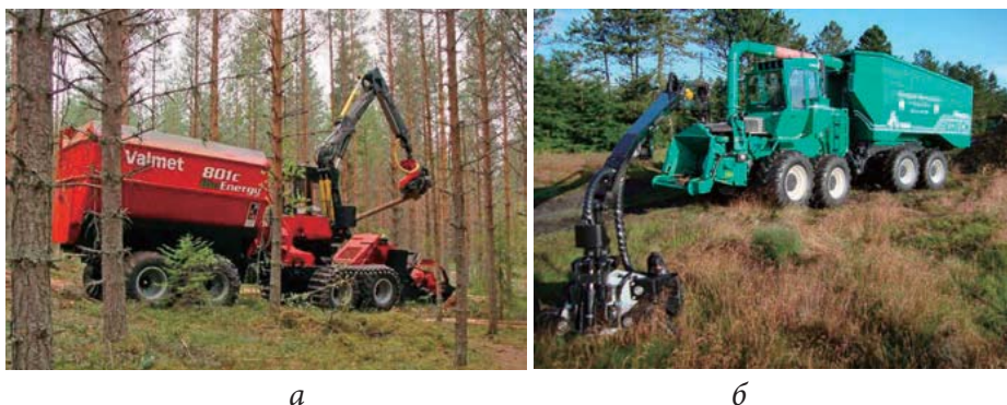
Рис. 2.32 Харвестер с рубительным модулем: а — Valmet 801 C Bio Energy Chipper [65]; б — Silvatec 878 CH [66]
