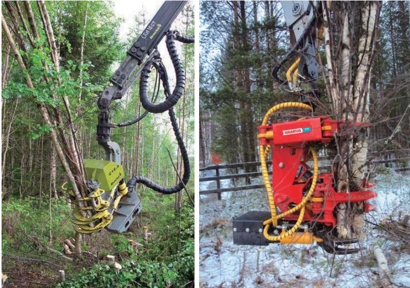
Рис. 2.29 Захватно-срезающее устройство с накопителем: а — Bracke C16.c [55]; б — Naarva E20 [57]
