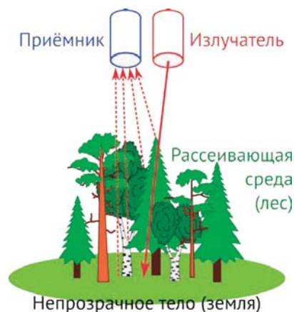
Рис. 3.3 Принцип действия Lidar
