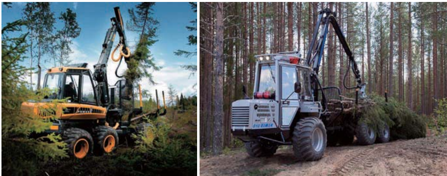
Рис. 2.30 Харвардер на заготовке тонкомерной древесины: а — Ponsse EH25 [58]; б — Vimek 160 [59]
