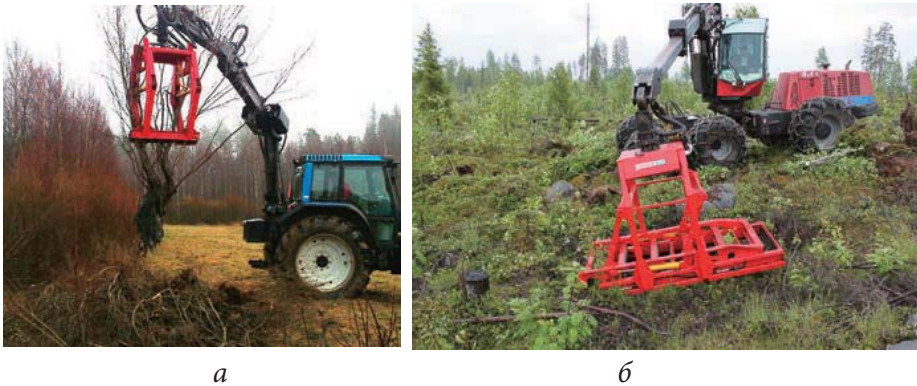
Рис. 2.33 Оборудование для осветления путем вырывания нежелательной растительности с корневой системой: а — Naarva Uprooter P16; б — Naarva Uprooter P25 [67]
