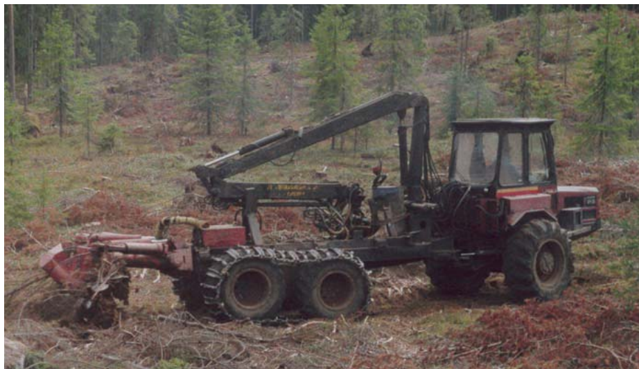
Рис. 1.15 Обработка почвы лесной бороной ТТS-Дельта (фото А. И. Соколова)
