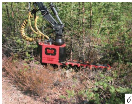
Рис. 2.27 Месторасположение мотоножниц: а — фронтальное Cangini Benne [54]; б — навесное на манипуляторе Mense RP [53]
