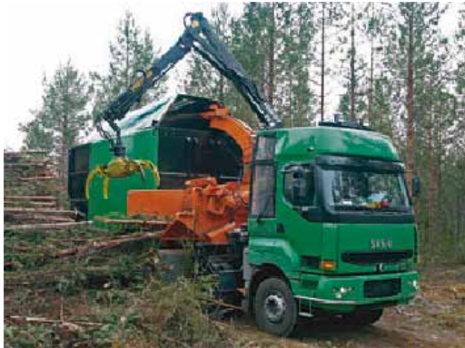
Рис. 1.56. Установка рубительной машины на шасси автощеповоза Sisu в агрегате с гидроманипулятором (фото «Sisu»)
