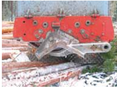
Рис. 2.45. Механизм прижима верхнего опорного сучкорезного ножа харвестерной головки Log Max 7000 (фото авторов)
