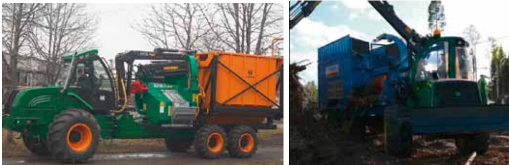
Рис. 1.57. Установка рубительной машины: а – Амкадор-2902 на базе форвардера Амкадор 2661 (фото «Амкадор»); б – Bruks 805.2 STC на базе форвардера John Deere серии E (фото «Bruks»)
