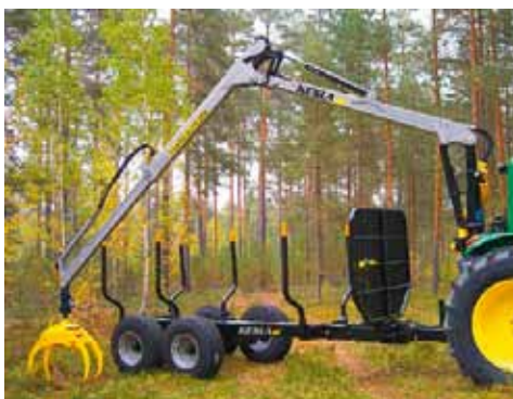
Рис. 1.31. Форвардер на базе колесного трактора общего назначения (фото «Kesla»)
