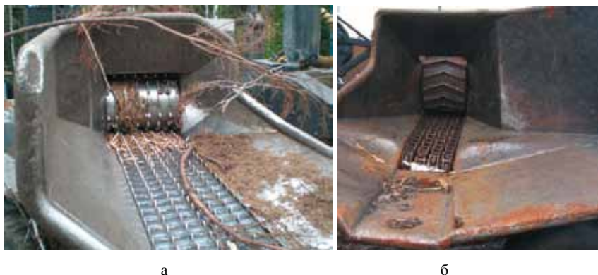
Рис. 1.47. Устройство для подачи сырья к рабочему органу: а – гусеничное; б – цепное (фото авторов)
