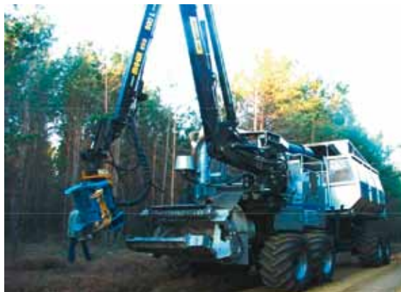
Рис. 1.58. Рубительная машина Silvatec 878CH (фото «Silvatec»)
