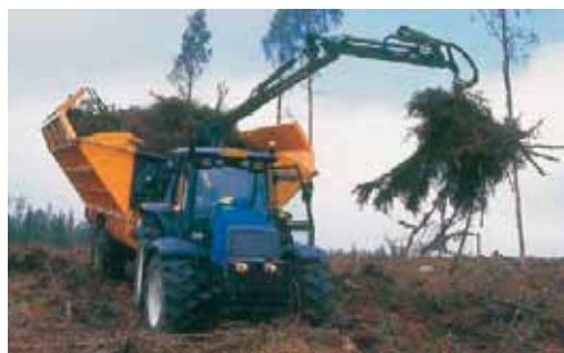
Рис. 1.41. Машина для сбора и транспортировки отходов на базе сельскохозяйственного трактора марки Navu Hukka фирмы Varo Oy (фото «Varo»)
