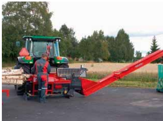
Рис. 1.63. Установка для производства дров Palax Combi M с приводом от сельскохозяйственного трактора (фото «Ylistaron Terästakomo»)
