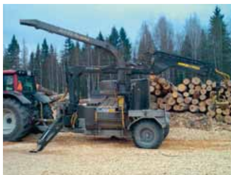
Рис. 1.50. Установка рубительной машины на одноосной прицепной тележке: а – Kesla 4560C с барабанным рабочим органом; б – УРП-1 с дисковым рабочим органом (фото авторов)
