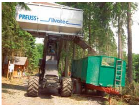
Рис. 1.59. Процесс перегрузки щепы (фото «Silvatec»)
