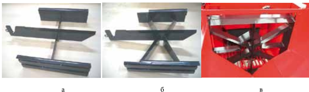
Рис. 1.65. Раскалывающие ножи: а – 4-секционный (крестообразный); б – 6-секционный (звездчатый клин) Jara 375TR PRO; в – 8-секционный Jara 450 (фото «Laitilan Rautarakenne»)
