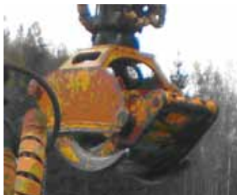
Рис. 1.38. Захватное устройство вильчатого типа (фото авторов)
