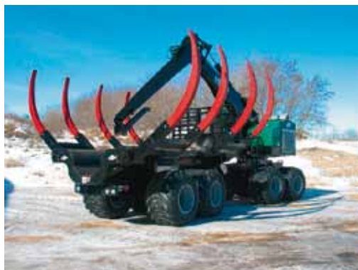
Рис. 1.40. Грузовая платформа машины TimberPro 810B (фото «TimberPro»)
