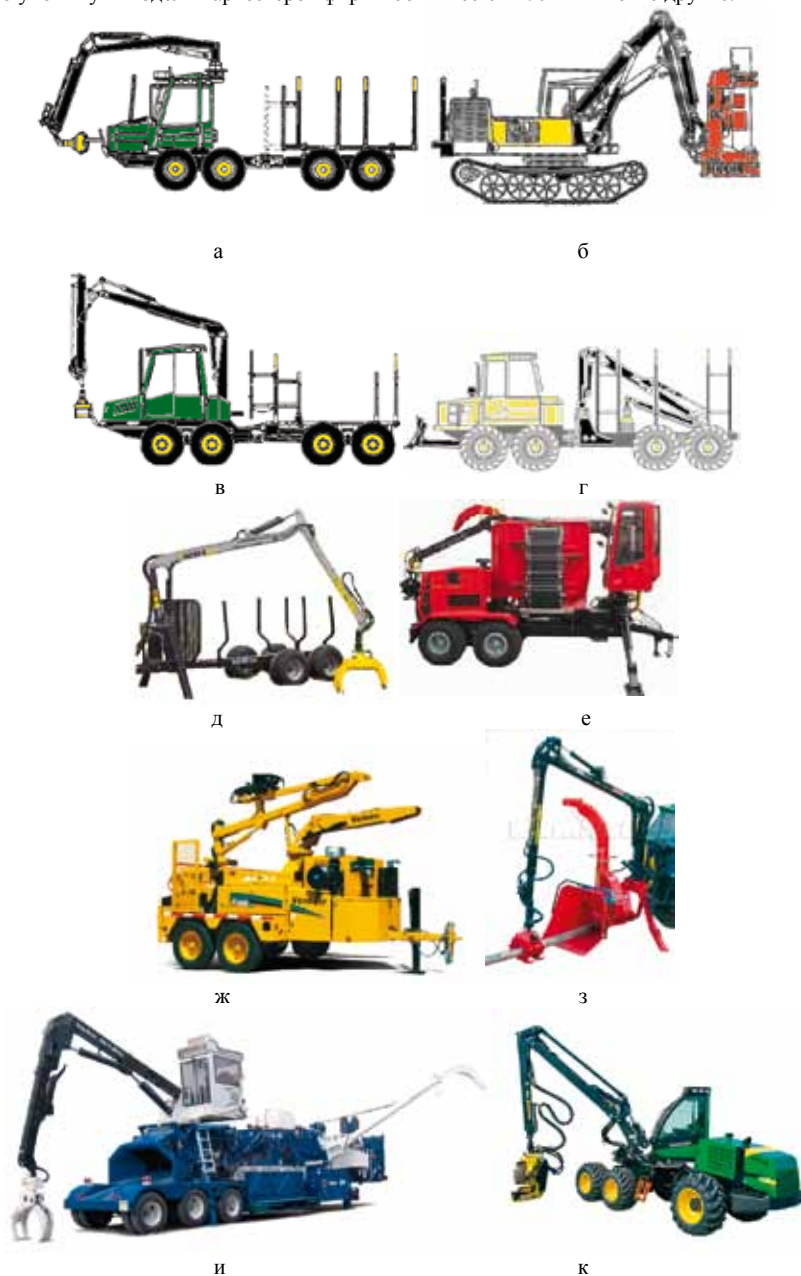
Рис. 2.3. Компоновочно-кинематические схемы сопряжения манипуляторов с базовой машиной: а – на кабине; б – вместе с кабиной на поворотной платформе; в – за кабиной на передней части рамы, г – за кабиной на задней части рамы; д, е, ж – на прицепе; з – на базовом тракторе; и – на полуприцепе; к – перед кабиной
