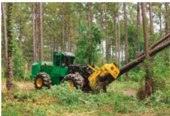
Рис. 1.9. ВПМ с фронтальным размещением технологического оборудования (фото «John Deere Forestry»)
