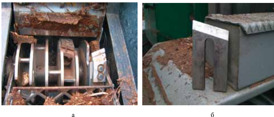
Рис. 1.46. Барабанный рабочий орган (а) и съемный нож (б) (фото авторов)
