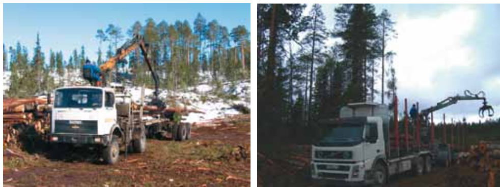
Рис. 1.34. Манипулятор, установленный на автолесовозе (фото авторов)
