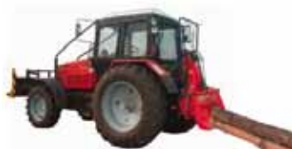
Рис. 1.27. Колесные трелевочные трактора: а, б – с тросочокерным оборудованием John Deere 640Н и Беларус ТТР-41; в – бесчокерный TimberPro TF840
