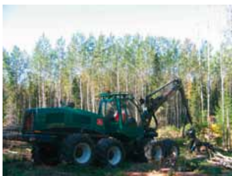
Рис. 1.7. Шарнирно сочлененные машины: а – форвардер John Deere 1510Е; б – харвестер Silvatec 8266TH Sleiþner (ЧЕТРА КХ451); в – шарнир соединения полурам с одной степенью свободы, Silvatec8266TH Sleiþner (фото авторов)
