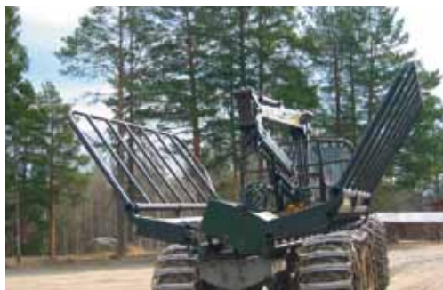
Рис. 1.39. Платформа форвардера для транспортировки лесосечных отходов Ponsse Buffalo (фото «Ponsse»)
