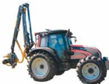
Рис. 1.25. Харвестер на базе колесного трактора Valtra
