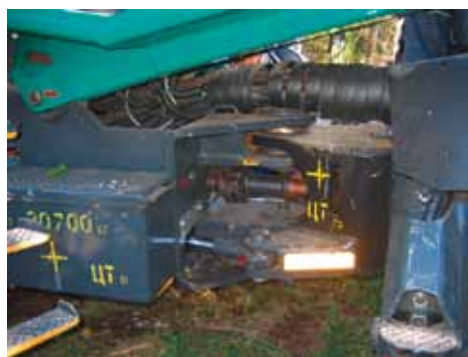
Рис. 1.7. Шарнирно сочлененные машины: а – форвардер John Deere 1510Е; б – харвестер Silvatec 8266TH Sleiþner (ЧЕТРА КХ451); в – шарнир соединения полурам с одной степенью свободы, Silvatec8266TH Sleiþner (фото авторов)
