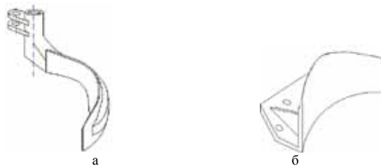
Рис. 2.46. Сучкорезные ножи: а – боковой подвижный (управляемый); б – опорный
