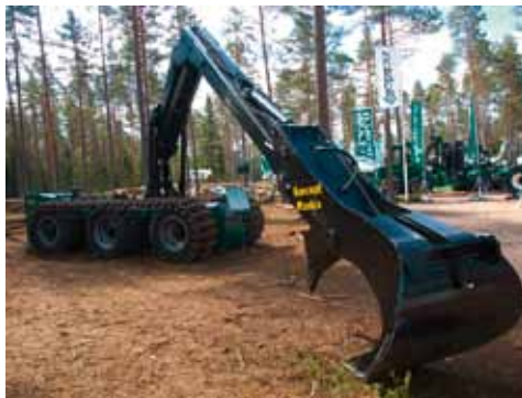
Рис. 1.67. Корчевальная машина Gremo Besten (фото «Elmia Wood»)
