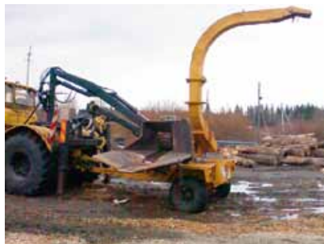
Рис. 1.50. Установка рубительной машины на одноосной прицепной тележке: а – Kesla 4560C с барабанным рабочим органом; б – УРП-1 с дисковым рабочим органом (фото авторов)
