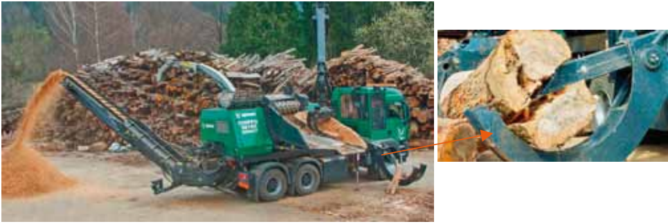
Рис. 1.55. Рубительная машина Komptech Chipro 5010С с автономным силовым приводным двигателем, гидроманипулятором и гидравлическими клещами (фото «Komptech»)
