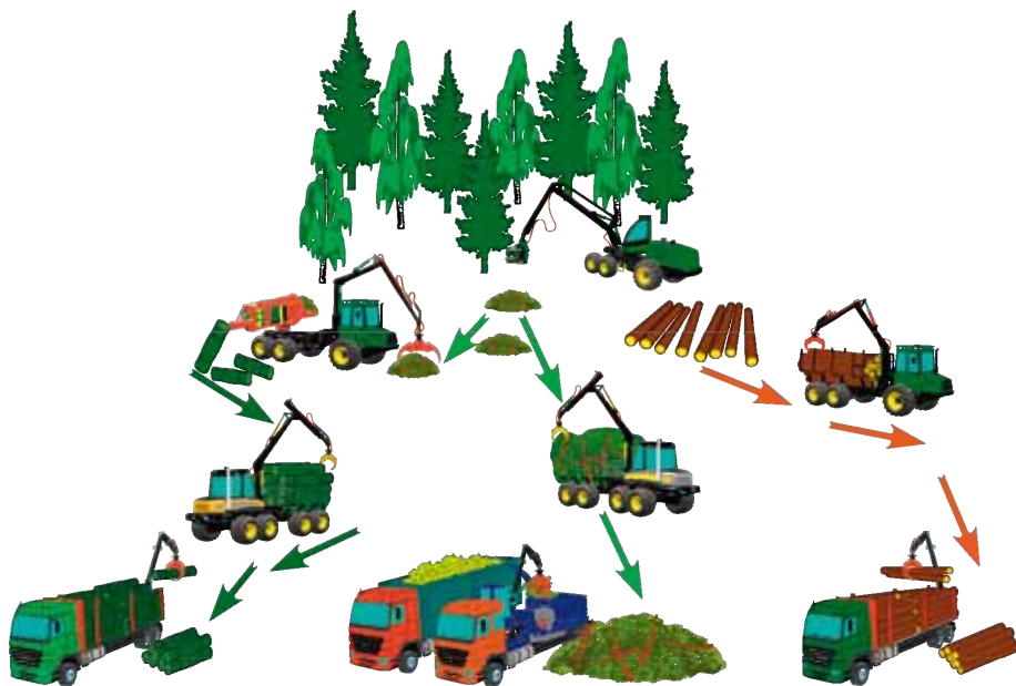
Рис. 1.1. Технологический процесс заготовки деловой древесины со сбором порубочных отходов для производства биотоплива
