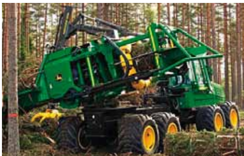
Рис. 1.42. Пакетизирующий модуль Fiberpac на базе John Deere 1490D (фото «John Deere Forestry»)
