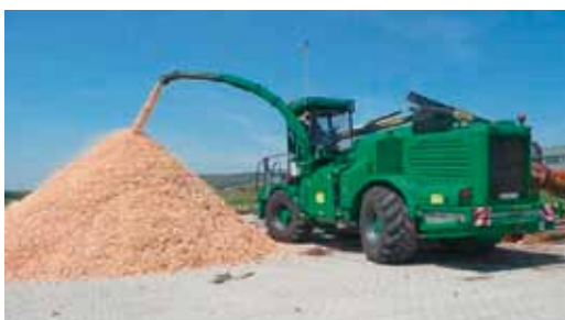
Рис 1.62. Рубильная машина Albach Silvator 2000 (фото «Albach Maschinenbau»)
