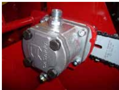
Рис. 3.6. Гидромотор пилы установки Яра 375Expert (фото Laitilan Rautarakenne Oy)
