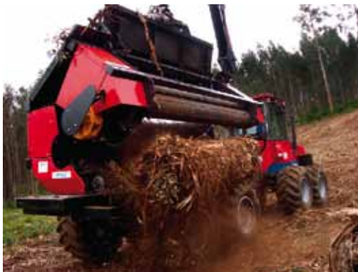
Рис. 1.43. Пакетизирующий модуль Wood Pac на базе форвардера Valmet (фото «Komatsuforest»)
