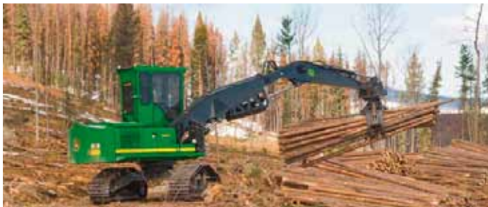
Рис. 1.35. Автономный манипуляторный погрузчик (фото «John Deere Forestry»)
