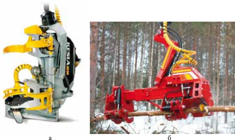
Рис. 2.44. Харвестерные головки с протаскивающим механизмом циклического действия: а – Kesla 20SH (фото «Kesla»); б – Tapio 160 (фото «Riuttotehto»)
