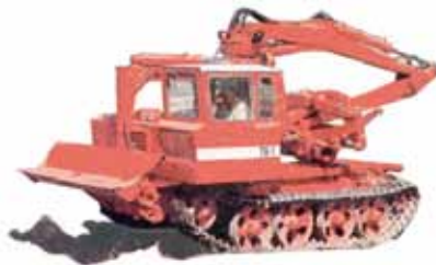
Рис. 1.26. Гусеничные трелевочные трактора: а – с тросочокерным оборудованием Онежец-300; б – бесчокерный ТБ-1МА-15
