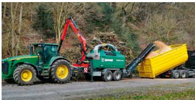
Рис. 1.49. Рубительная машина Komptech Chipro 510C на прицепной тележке, оснащенная щепопроводом и транспортером для выброса щепы (фото «Komptech»)
