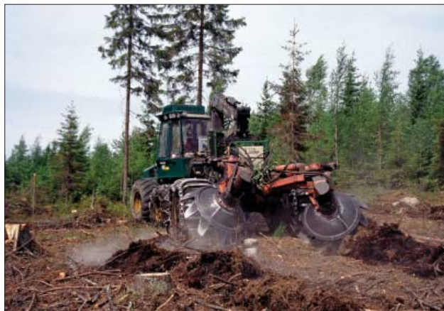
Рис. 10. Лесная борона, к которой можно подключать пневматическую сеялку с автоматическим дозатором семян. Куоревеси, Финляндия. Фото: Маркку Туртияйнен
