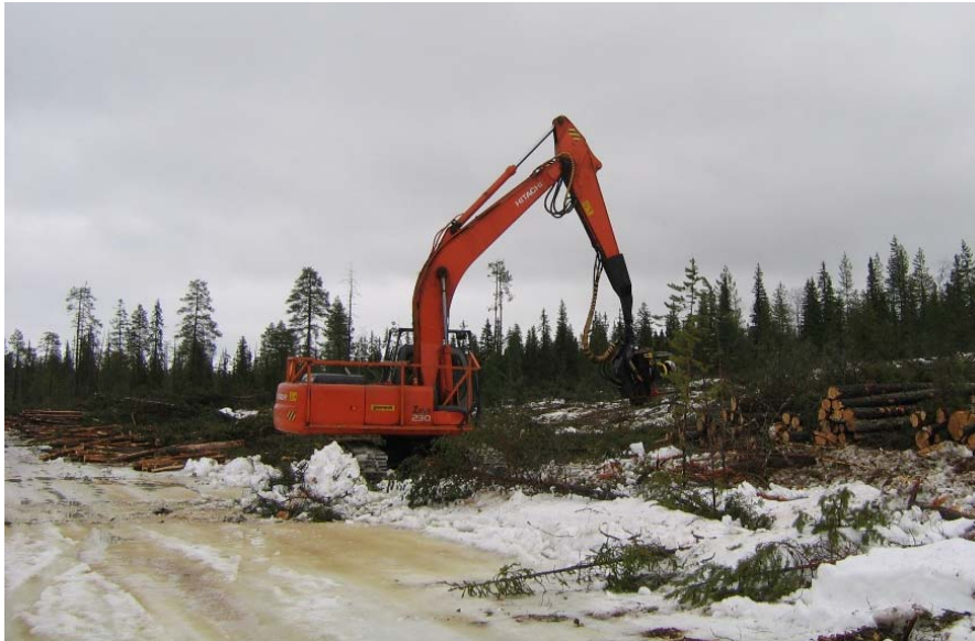
Kuva 4. Katkonnassa prosessorina toimiva hakkuukone Hitachi Zaxis 230 kuormauspaikalla. (OAO Mujezerskij LPH, kuva kirjoittajan, 2007)
