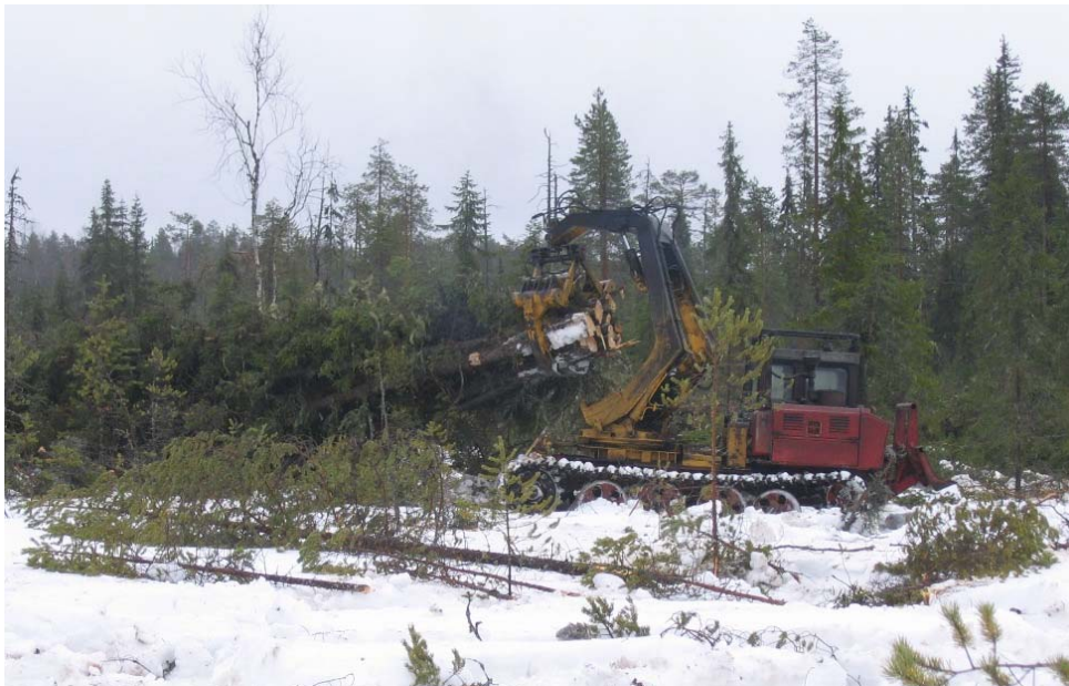
Kuva 3 Puunippujen juonto kuormauspaikalle telajuontotraktorilla ML-136. (OAO Mujezerskij LPH, kuva kirjoittajan, 2007)
