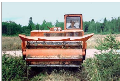
Рис. 18. Каток-осветлитель культур КОК-2. (фото А.В.Жигунова)
