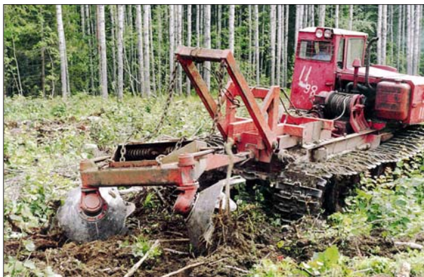
Рис. 6. Обработка почвы полосами с помощью дисковой бороны TTS-20, агрегатированной с трактором ТЛТ-100. (фото А.И.Соколова)
