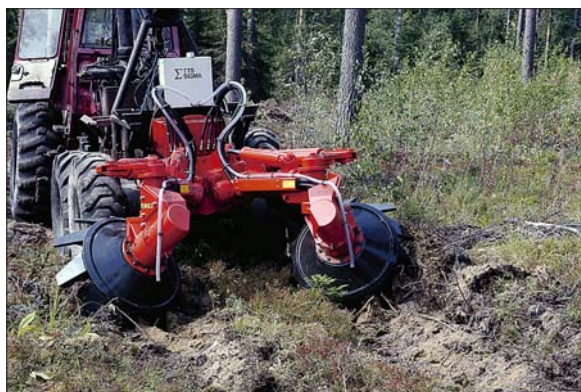
Рис. 14. При механизированном посеве семена попадают прямо на дно только что образованной борозды во влажный слой почвы. (фото АО Метсятехо)
