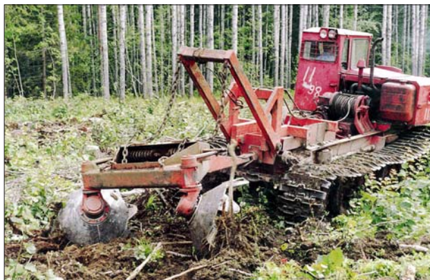
Kuva 6. Äestystä TTS-20-lautasäkeellä, jota vetää TLT-100-traktori.
